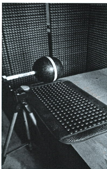
Рисунок 13. Розташування теплового стимулятора при проведенні вимірів в радіочастотній безеховій камері.
